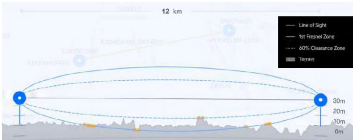
Afbeelding 5: de Ubiquiti netwerk planning tool ( https://link.ui.com ) toont of obstakels in de eerste Fresnel zone zitten (volle blauwe lijn), voor een gegeven pad tussen 2 opgestelde antennes (Fresnel zones enkel voor UHF en SHF).
